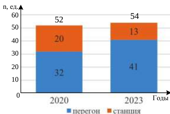
Рис. 2. Количество отказов изоляторов на перегоне и станции
