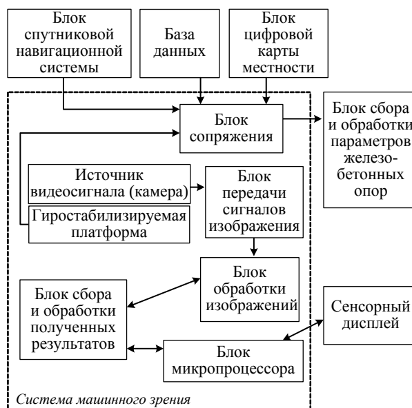
Рис. 1. Алгоритм дистанционного метода определения состояния опор контактной сети
