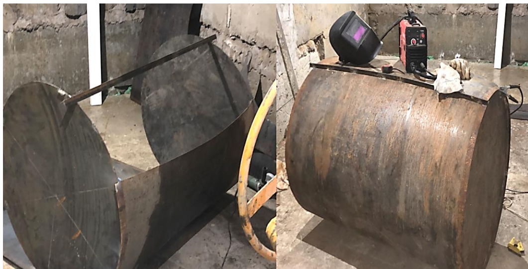
Рис. 1. Процесс сборки емкости экспериментального стенда
