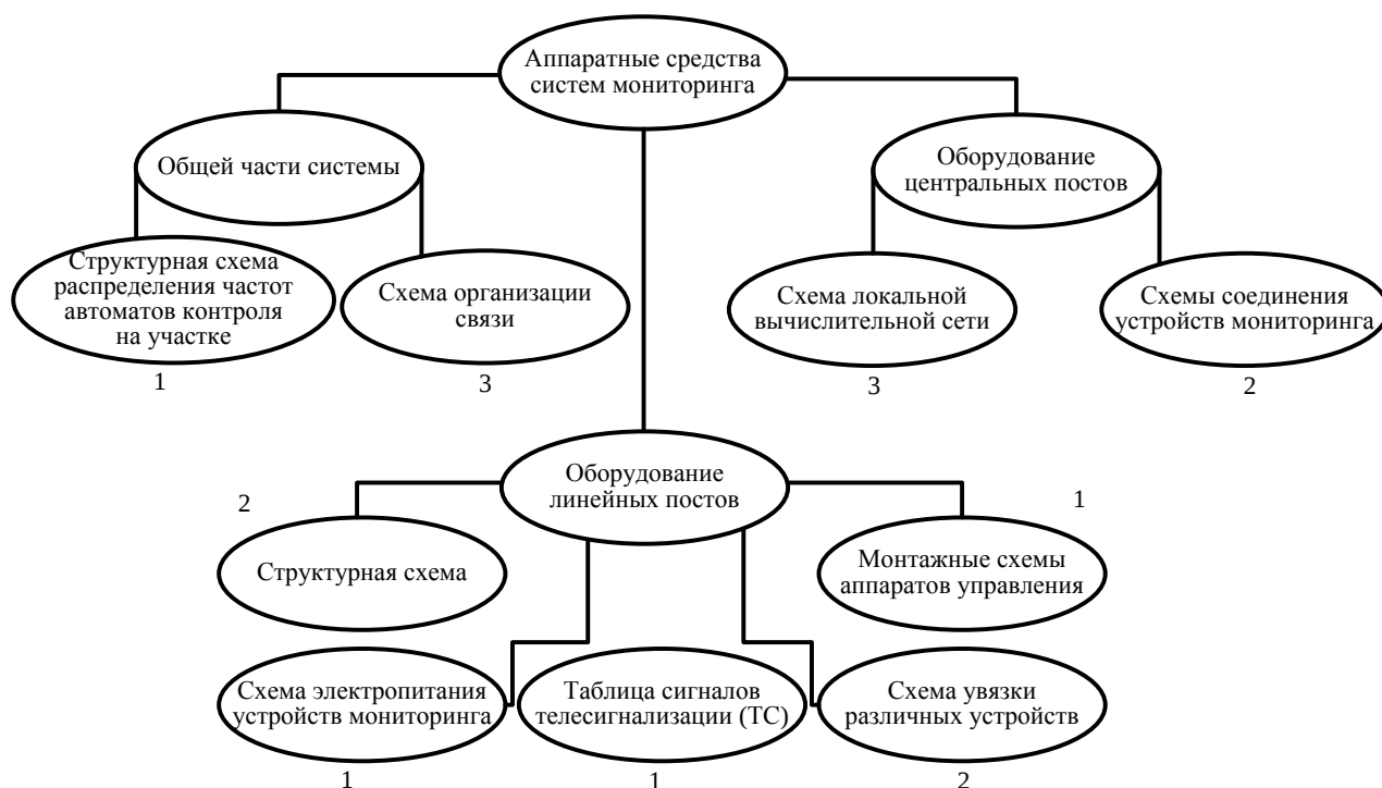
Рис. 2. Структура проектирования аппаратных средств мониторинга устройств ЖАТ
