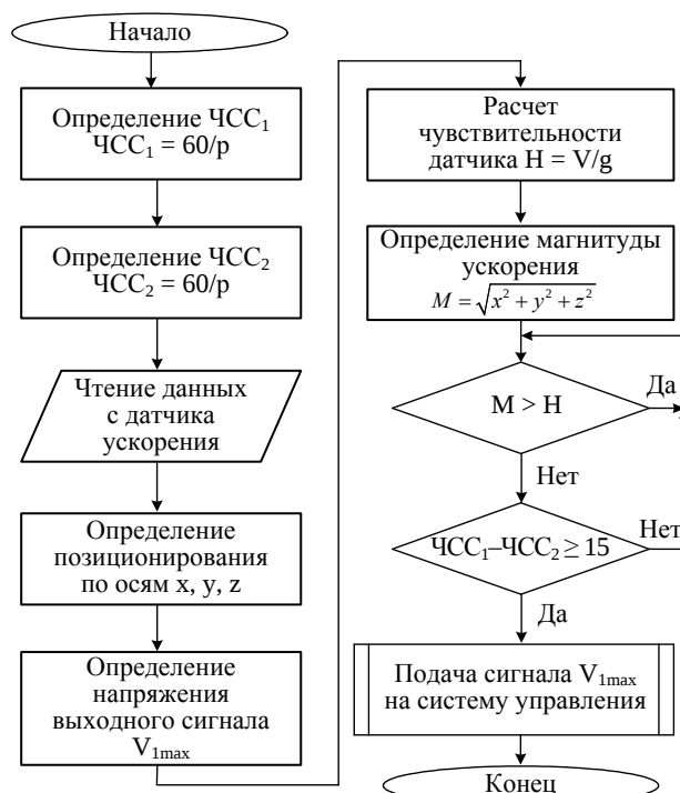
Рис. 5. Алгоритм работы системы контроля бдительности машиниста
