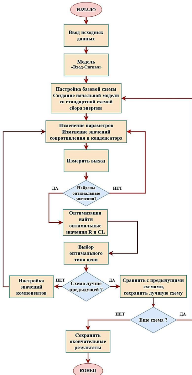
Рис. 1. Алгоритм оценки мощности электрических схем для пьезоэлектрического преобразования энергии
