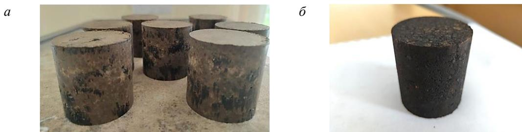
Рис. 1. Внешний вид образцов укрепленного грунта: а – вязкий битум; б – разжиженный битум
