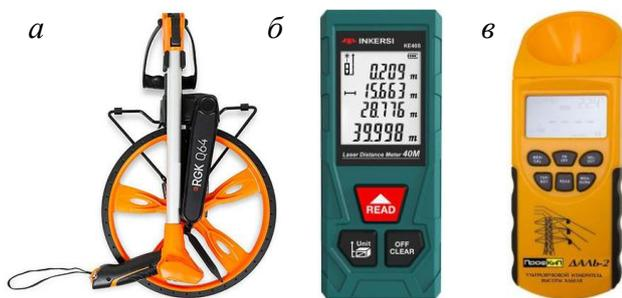
Рис. 5. Измерительные приборы: а – курвиметр; б – лазерная линейка; в – ультразвуковой измеритель Даль-2
