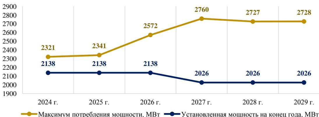
Рис. 3. Баланс электрической мощности энергосистемы Хабаровского края и Еврейской автономной области
