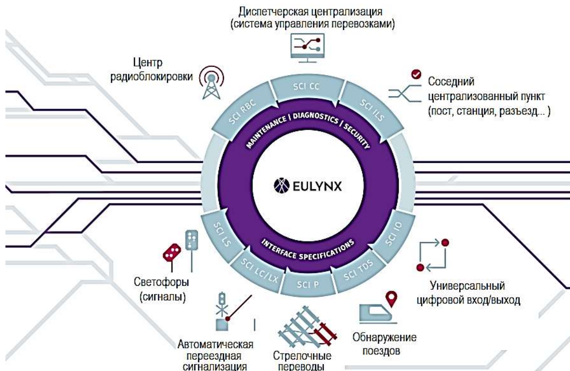
Рис. 1. Европейская модель объединения систем и устройств железнодорожной автоматики
