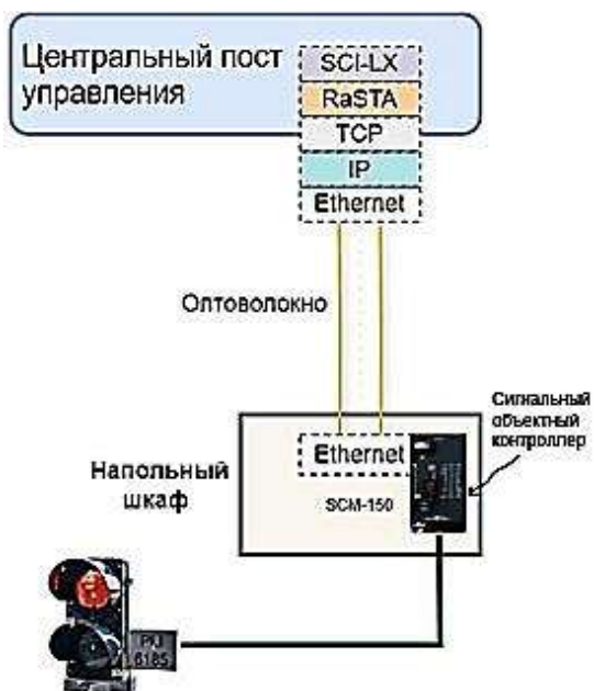
Рис. 2. Схема взаимодействия диспетчерского центра со светофором через стек протоколов
