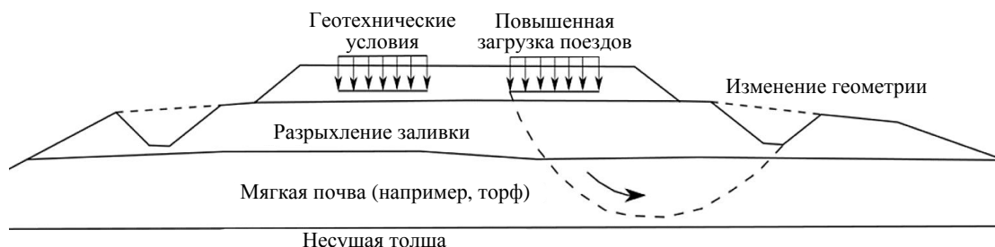
Рис. 1. Основные факторы, влияющие на осадку железнодорожных насыпей [8]
