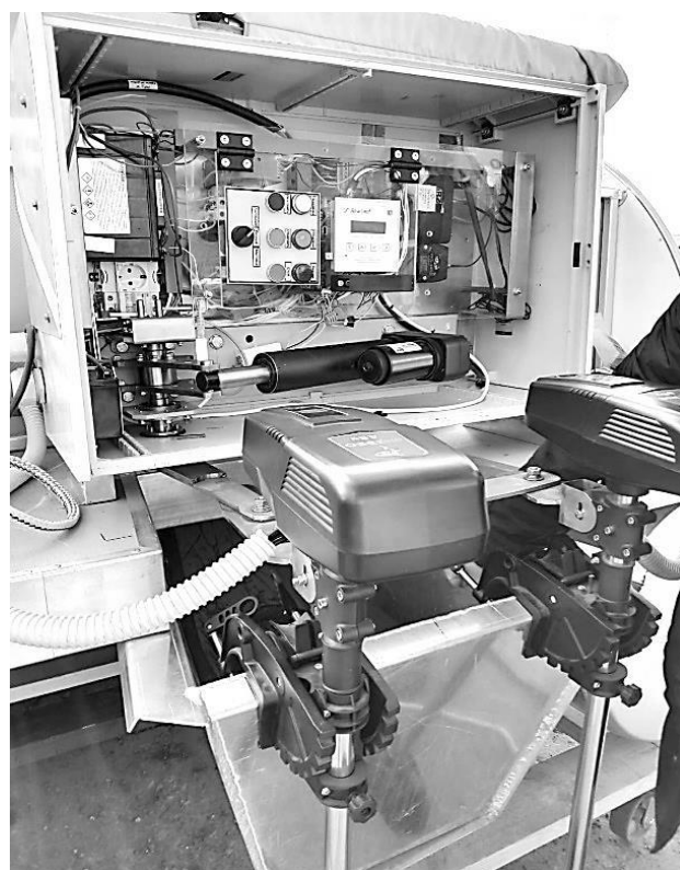
Рис. 6. Внешний вид САУ РМП-ВЭУ с установленными гребными электродвигателями
